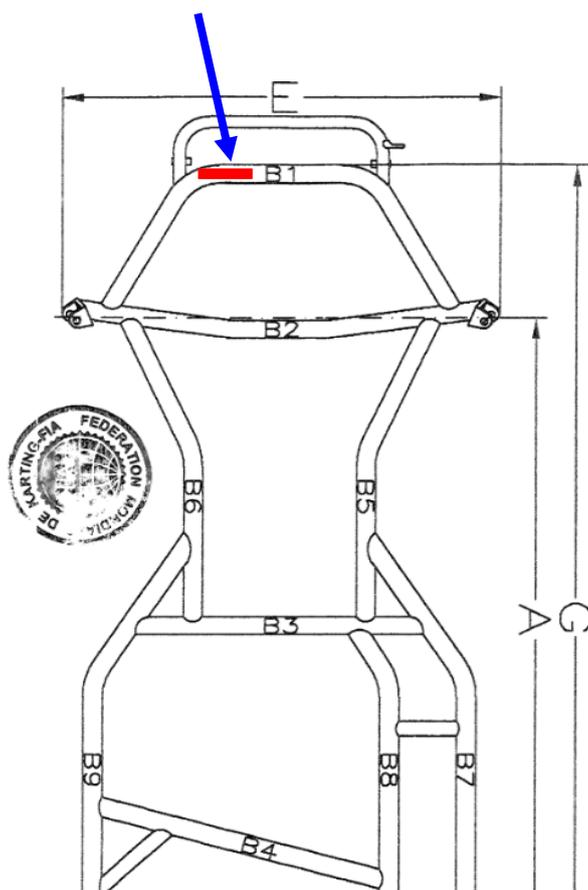
Le dessin technique sert pour identifier la structure et la géométrie principale du cadre, mais seulement les dimensions (dans la fiche peuvent faire l'objet de contrôles et d'une éventuelle remarque lors d'un contrôle technique. The technical drawing of the structure and the main geometry of the frame. Only the dimensions (measurements) and the quantity indicated verification and eventual remarks at scrutineering.
