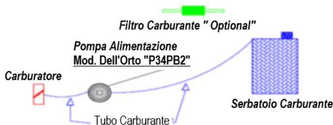
E' Possibile utilizzare 1 solo filtro benzina. Montaggio solo ed esclusivamente nel tratto che va dal Serbatoio alla Pompa Benzina
