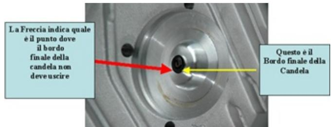
b) **Volume della camera di combustione:** 6,8cm<sup>3</sup> min., verificabile come da procedura (allegato 1).
